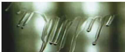
Вследствие неравномерного нанесения материала, на поверхности местами образуются наплывы или происходит сползание материала.
