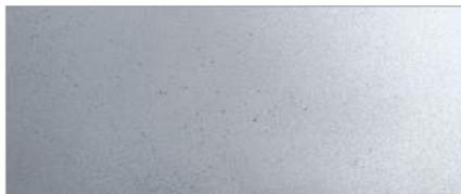
Неравномерный цвет, полосы или пятна более светлого или темного оттенка, частично на лакокрасочном покрытии.
