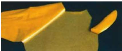
Плохое прилипание и отслоение покрытия от подложки, например, между: краской и лаком и/или грунтом; новым и старым покрытием; грунтом и голым металлом или пластиком и т.п.
