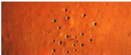
Микроотверстия на поверхности ЛКП, похожие на поры на поверхности кожи или проколы от иголки, принадлежащие в нижележащие слои покрытия, возникают частично или неравномерно по всей поверхности.
