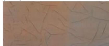
Возникновение трещин или линий различной ширины, длины и глубины на покрытии.
